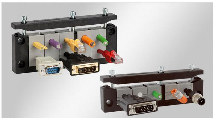
Teilbare Kabeleinführung für Leitungen mit Stecker. Abhängig von der Baugröße können Leitungen von 1 bis 16 mm (Einfachtüllen KT 1 - 15) bzw. 13 bis 35 mm (Einfachtüllen KTG 13 - KT 34) Durchmesser eingeführt, mit IP66 / UL Type 12/4X\* abgedichtet und zugleich nach DIN EN 62444 zugentlastet werden.
