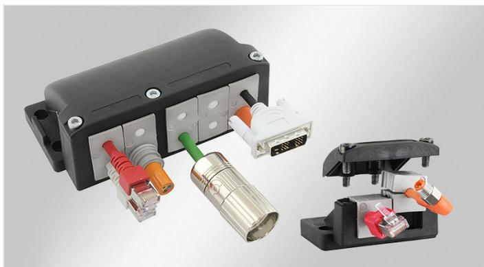
Die Kabeleinführung KEL-FG ermöglicht die Einführung, Abdichtung und Zugentlastung (nach DIN EN 62444) von Leitungen im 90° Winkel zum Gehäuse. Leitungen mit und ohne Stecker sowie Schläuche können geordnet eingeführt werden.
