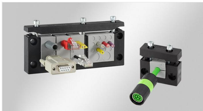
Teilbare Kabeleinführung für Leitungen mit Stecker mit Schutzart IP54 / UL Type 12. Leitungen von 1 bis 35 mm Durchmesser können eingeführt, abgedichtet und zugleich gemäß DIN EN 62444 zugentlastet werden.
