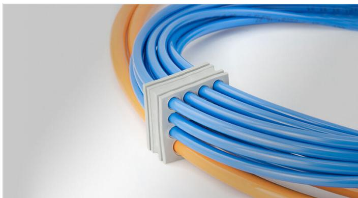
Die KT-DT Durchführungstüllen sind überall dort einsetzbar, wo eine hohe Anzahl an elektrischen, pneumatischen oder hydraulischen Leitungen durchgeführt und mit IP54 abgedichtet werden muss. Durch den Einsatz der KT-DT Durchführungstüllen lässt sich die Packungsdichte deutlich erhöhen.
