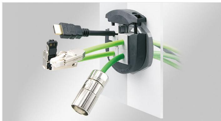
Die KVT-ER ist eine teilbare Kabelverschraubung, die die Einführung von konfektionierten Leitungen oder fertigen Kabelsätzen ermöglicht. Aber auch nicht konfektionierte elektrische, pneumatische oder hydraulische Leitungen sowie Wellschläuche lassen sich mit der teilbaren Kabelverschraubung KVT-ER problemlos in Schaltschränke, Gehäuse oder Maschinen einführen, abdichten und gegen Zug entlasten.
