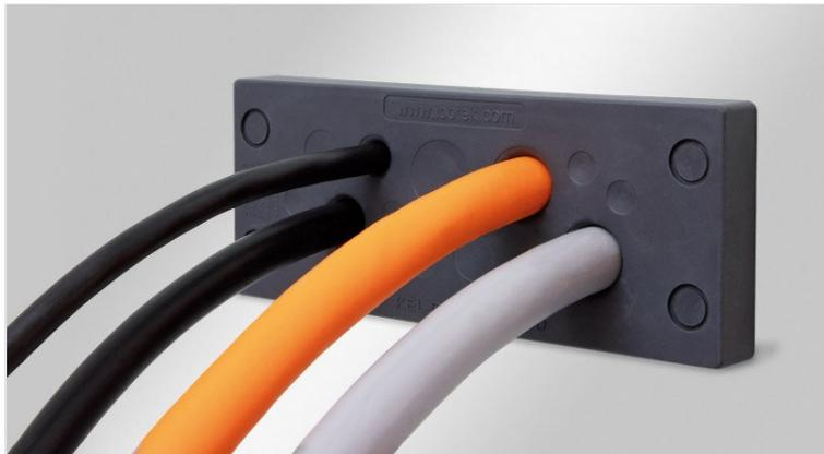
Die KEL-DPU-OD ist bestens geeignet für Anwendungen, bei denen Kabeldurchführungen dauerhaft starker UV-Strahlung, Witterungseinflüssen und Temperaturschwankungen ausgesetzt sind. Im Vergleich zu Standardausführungen bietet sie erhöhte Materialbeständigkeit und verlängerte Standzeiten in Außenumgebungen. Sie ist dank ihrer Zulassungen besonders für den Einsatz in Photovoltaikanlagen (nach UL 6703, UL 6703A, UL 3703, UL 1703) geeignet.
