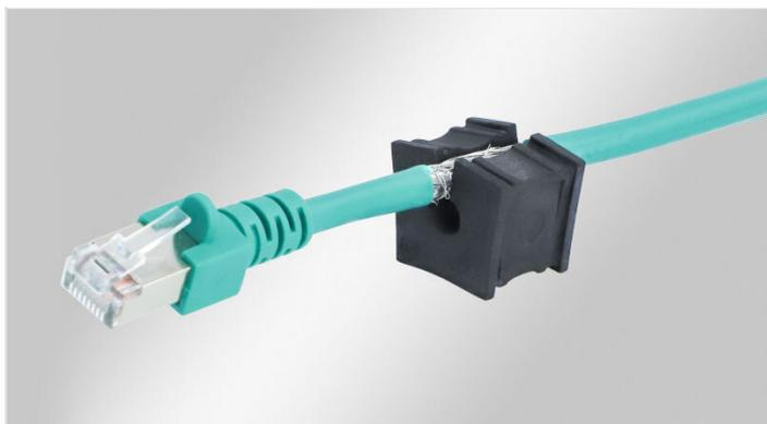
Les joints fendus type CEM-KT sont également fabriqués dans un élastomère spécialement conducteur. Les perturbations sont ainsi dissipées directement depuis le blindage du câble grâce aux joints fendus, au cadre et au joint plat de montage.
