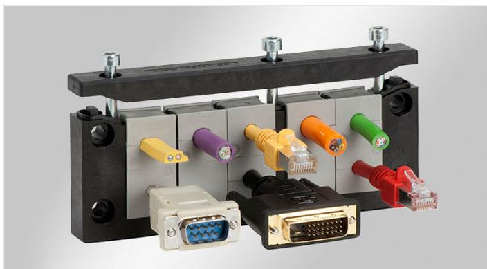
Système divisible pour le passage de câbles et faisceaux équipés de connecteurs ainsi que des gaines et tuyaux pneumatiques, avec étanchéité IP66 / UL Type 12/4X. Possibilité de passage de 1 à 16 mm (KT 1 - 15 seul trou) et de 16 à 35 mm (KT 16 - 34 seul trou) avec fonction serre-câble selon EN 62444.
