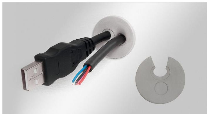
Les KEL-QTE sont des plaques passe-câbles divisibles qui se clipsent directement sur une tôle de 1.5 à 2.5 mm d'épaisseur. Le système KEL-QTE permet d'introduire des câbles pré confectionnés et non pré confectionnés.
