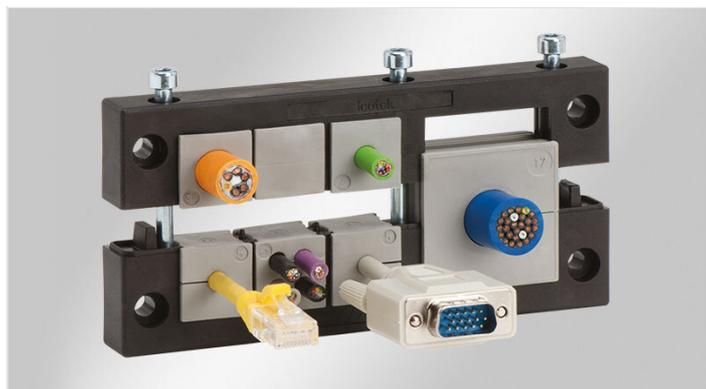
Système divisible au milieu pour le passage de câbles et faisceaux équipés de connecteurs ainsi que des gaines et tuyaux pneumatiques, avec étanchéité IP54 / UL Type 12 et fonction serre-câble selon EN 62444.
