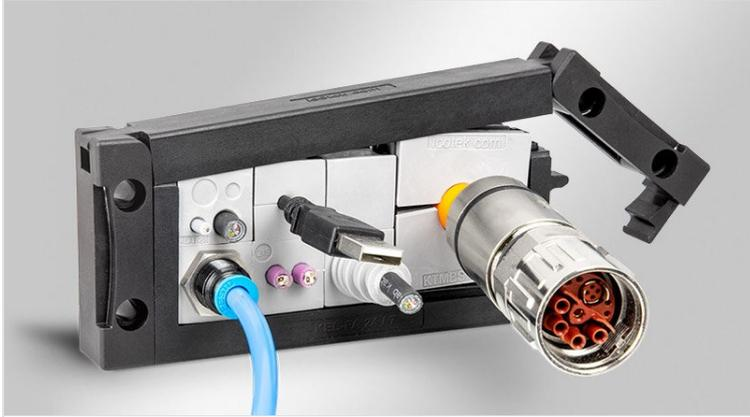
KEL-FAシリーズは、コネクタ付きケーブルやホース、空圧ラインなどを挿入・シールするためのコンパクトなシステムです。KTグロメットを使用します。直径1～35mmのケーブルを挿入でき、IP54/ULタイプ12でシールできます。フレームにKTグロメットシステムを装着した後、上蓋がベースフレームに装着されると、同時に2つのクランプレバーが押し下げられ、グロメットを圧縮し底部にしっかりと固定されます。KEL-FAは、ねじれに強い構造により、フレキシブルな組み立てが可能です。
