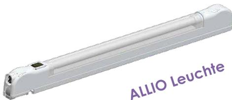
**All in one** deshalb, weil die Leuchte mit einem Weitspannungs-EVG 100-240 V/50-60 Hz und dem patentierten Befestigungssystem ausgestattet ist. Die Montage ist mit und ohne Werkzeug möglich und immer mit Magnet versehen. Mit einer Breite von 26 mm ist ein Einsatz auf kleinstem Raum gegeben.
