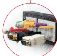
Grados de protección desde IP54 hasta IP66 gracias a la presión ejercida en el apriete entre las dos partes del marco y la acción de las juntas de estanqueidad.
