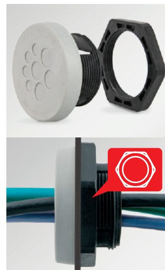
Tipo di montaggio 2: Avvitato con un controdado Per spessore parete max. 11 mm
