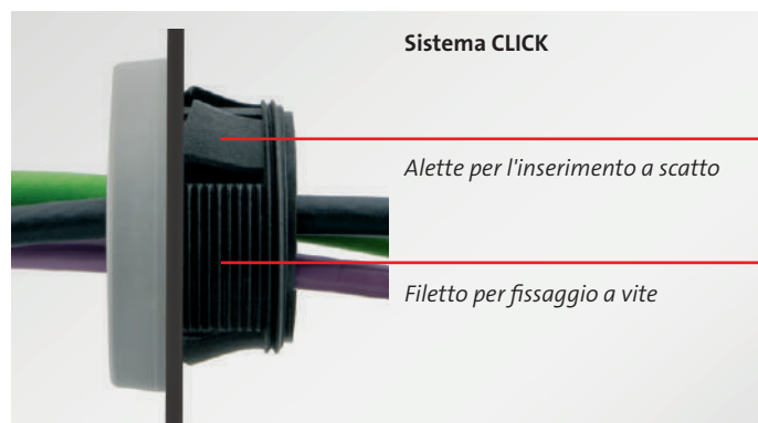
Tipo di montaggio 1: Innestato nella foratura Per spessore parete 1 – 2,5 mm
