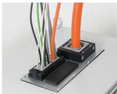
Introduction de câbles d'alimentation rigides avec une plaque modulaire sur le toit d'une armoire. Dimensions de la découpe 314 x 144 mm.
