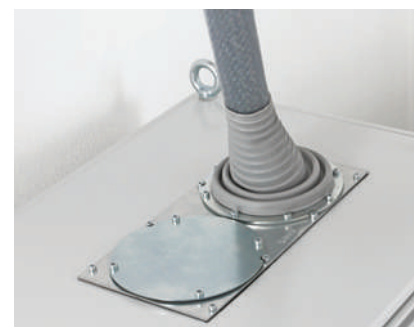
Introduction d'un câble d'alimentation rigide avec une plaque modulaire sur le toit d'une armoire. Dimensions de la découpe 314 x 144 mm.
