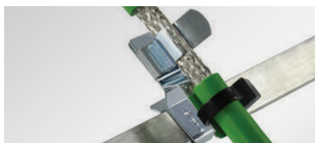
Bornes de blindage CEM pour barre collectrice 10 x 3 mm avec ou sans maintien de câble
