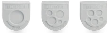
UT-DTメンブレン（薄膜）ケーブルグロメットには、ケーブル末端が未処理の物を配線します。UTケーブルグロメットを使用している箇所であれば取付けられます。ケーブルが増えても高密度に配線できます。取り付ける筐体の板厚は1~4mmです。筐体材質は、樹脂製、金属製、アルミ製ダイキャスト製品に対応します。
