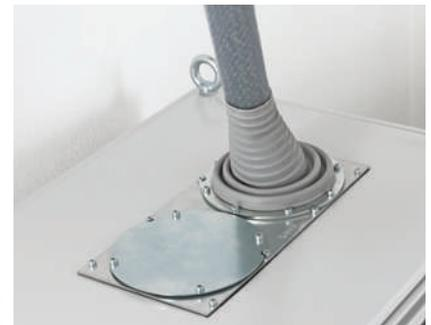
モジュールプレートで密閉形キャビネットの天板に通す、硬い電源供給用ケーブルの経路。取付け穴314×114mm。
