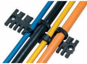
ストレンリリーブプレートZLの特長は、異なる幅の組合せです。さまざまなケーブルサイズに対応する多目的製品です。このユニットは、EN 62444によるストレンリリーブができる様に設計されています。ケーブルや空圧チューブが、結束バンドの使用により簡単な取付けができます。
