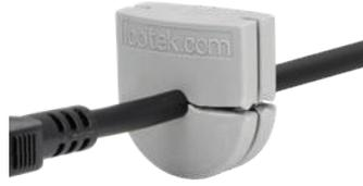
UT分割形ケーブルグロメットは、ケーブル末端にコネクタ類の有無は問わず、筐体へ簡単かつコスト効果の高い製品です。保護等級はIP54です。取付カットアウトはU字型形状です。UTは、4~11mm径の部品を挟むことができます、ケーブル、圧空ホース、ガラス繊維チューブ。筐体の板厚は1~4mmに対応しています。
