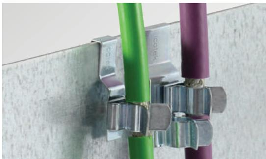
ケーブルシールドがアース電位につながる箇所はどこでも、EMCシールドクランプは使用されます。シールドクランプは簡単に使用でき、電磁干渉に効果的です。
