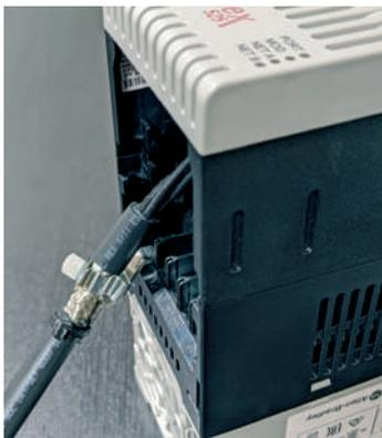
\*\* LFZ-U-ABは、例えばAllen Bradley社のインバーター Powerflex 525/527 ACドライブへの実装に特に適しています。変換器へ直接的な取付けはスペースを節約し、信号ノイズはノイズ源で直接低減されます。
