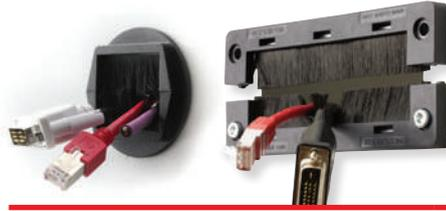
分割式ブラシプレートKEL-BES-Sサーバーラック、制御盤や電気キャビネットのケーブル配線用です。ブラシプレートはネジもしくはプッシュリベットどちらでも取付けできます。分割式のため、KEL-BES-Sは、引込みケーブルを後から装着できます。KEL-BES-Sフレームは、10芯、16芯もしくは24芯の標準産業用コネクタの取付け寸法と合致しています。
