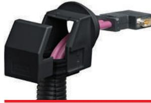
分割式ケーブルグランドKVT-W90は、端末処理済みケーブルやコンジットを挿入しシールして90°曲げて取付けて使用します。
