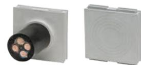
KEL183は、最大径75mmのケーブルやホースの挿入が可能で、保護等級最大IP54でケーブルをシールします。KTケーブルグロメットは、最大径35mmのケーブルに使用され、そのスリット入りデザインにより、コネクタ付きケーブルの挿入が可能です。
