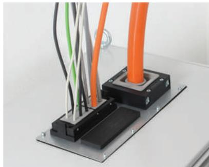
モジュールプレートで密閉形キャビネットの天板に通す、複数のコネクタ付きやコネクタ無しケーブルの経路。取付け穴314×114mm。
