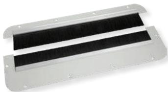
分割形フランジプレートには、それぞれ2本のブラシが付いています、それらは35mmと50mm長です。これによりコネクタ付きケーブルの配線が可能になり 筐体への汚れの確実に侵入を防ぎます。フランジプレートは、Rittal社のAXタイプのエンクロージャー用に設計されています。
