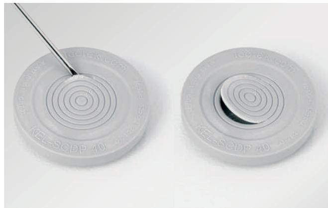
1本用のメンブレンリングは、配置するケーブル/ホース直径に応じて剥がします。剥離方法としては、リング間の凹み部に小さな穴を1つ刺します。その後、対応するリングを取り除きます。
