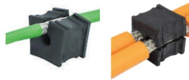
EMV-KTタイプのケーブルグロメットは、導電性エラストマーで作られており、ケーブルシールドからの干渉（ノイズ）が、グロメット・フレーム・フラットガスケットを介して直接伝導され、解消されます。
