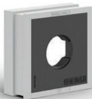
QT-AT-Mは、メートル雌ネジ付き（ラージQTグロメットに基づいた）グロメットです。アイコテック社製ケーブルエントリシステムに適合します。QT-AT-Mグロメットは、ポリアミド製部品とエラストマで構成されています。QT-AT-Mグロメットは、雌ネジM12x1.0、M16x1.5、M20x1.5、M25x1.5を用意しています。
