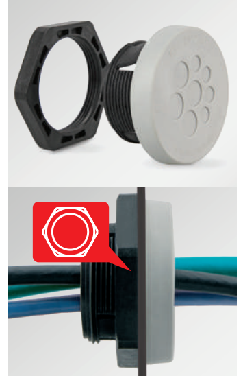
마운팅 타입 2: 잠금너트를 이용해 스크류 방식으로 조립 최대 판두께 11mm
