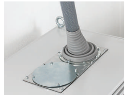
엔클로저 상부의 모듈플레이트 공급선 장착 사례 (타공사이즈 314 x 144mm)
