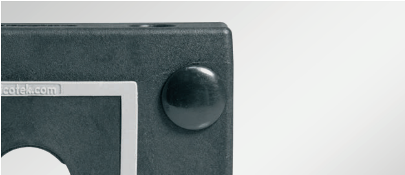
전면에서 나사로 고정시에는 나사 헤드의 홀을 커버플러그 B 블랙(주문번호 99200) 또는 커버 플러그 C 그레이(주문번호 99201)로 막을 수 있습니다. 커버 플러그는 M5 DIN 912 나사에만 사용할 수 있습니다.
