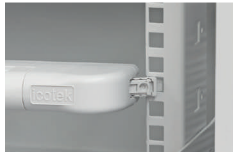
Montaż zatrzaskowy w szafie rack 19"
