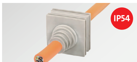
Wielozakresowe moduły uszczelniające Stopień ochrony IP54 Dla przewodów o średnicach od 3 do 26 mm
