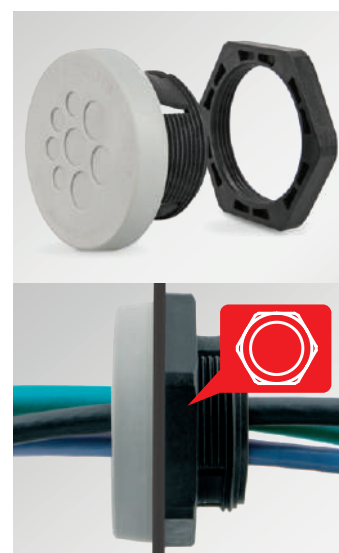
Sposób montażu 2: Przykręcany nakrętką zabezpieczającą Dla max. grubość ścianki 11 mm
