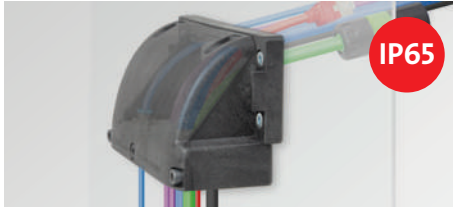
Flanş kutusu, 90° kablo girişleri enjekte contalı 1 ile 35 mm arası kablo çapları için
