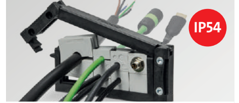
Ayrılabilir kablo girişi „Fast Assembly“ Aletsiz montaj için 1 ile 35 mm arası kablo çapları için
