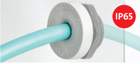
Vidalı kablo geçiş plakası M25 – M63, 52 mm'e kadar olan kablo çaplarına uygun KEL-SCDP-TR
