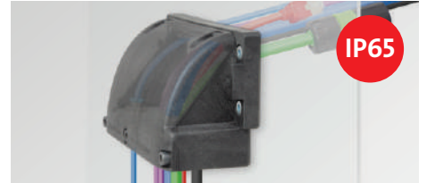
Flanş kutusu, 90° kablo girişleri enjekte contalı 1 ile 35 mm arası kablo çapları için
