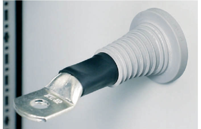
Malzemenin esneklięi sayesinde kablo pabuları da geirilir
