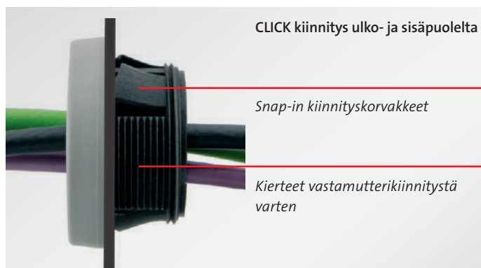
Asennustapa 1: "Snap-in", painamalla asennusaukkoon Seinäävahvuuksille 1–2.5 mm
