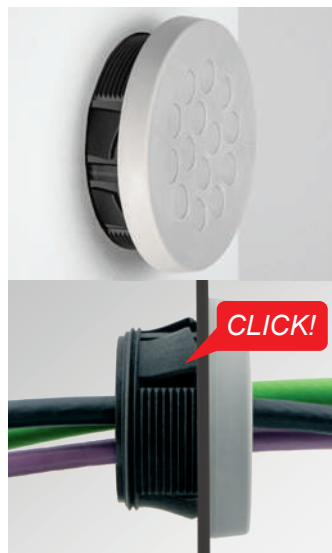
Způsob instalace 1: Zacvaknutí do výřezu Pro tloušťku stěny 1 – 2,5 mm
