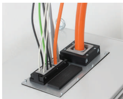
Zavádění kabelů různých průměrů do uzavřeného stropu rozváděče, pomocí vymezovacího plechu. Rozměr výřezu 314 × 144 mm.
