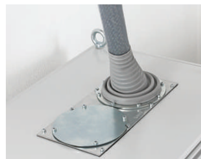
Zavádění neohebného napájecího kabelu do uzavřeného stropu rozváděče, pomocí vymezovacího plechu. Rozměr výřezu 314 × 144 mm.
